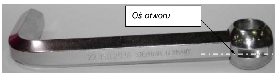
Rysunek 18: Przykład - montaż kuli zaworu
