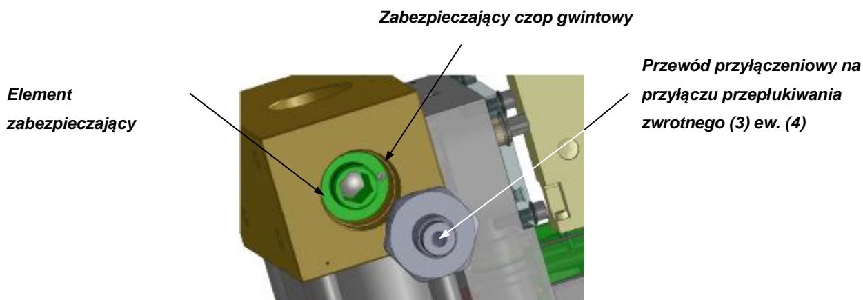
Rysunek 12: Demontaż przyłącza dla przepłukiwania zwrotnego 1
